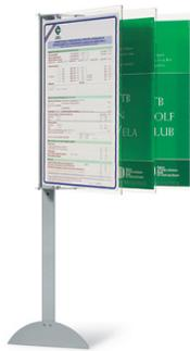
Portamanifesti 50x70 cm a tre pagine mobili in plexiglas con predisposizione per otto lastre. Struttura in tubolare di acciaio e piastre semicircolari a forte spessore; doppia lastra in plexiglas con profilo in ferro, incernierata alle piastre con viti a brugola. La dotazione standard del display è di tre pagine. Finitura a polveri epossidiche colore argento.
